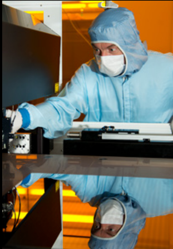
En tekniker monterar och justerar en maskritare i en renrumsmiljö. Inom affärsområdet mönsterritare utvecklas utrustning för tillverkning av bildskärmar.
